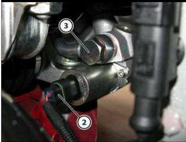
● 更换相应的密封件并拧紧管接头 (3)。
